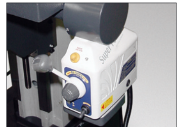
Cod. 40026 Power: Avanzamento automatico longitudinale meccanico della tavola.
