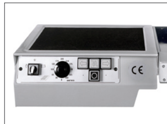
Cod. 40005: Avanzamento autom. long. elettronico della tavola. 36÷380 mm/min. Avanzamento rapido 3 m/min.
